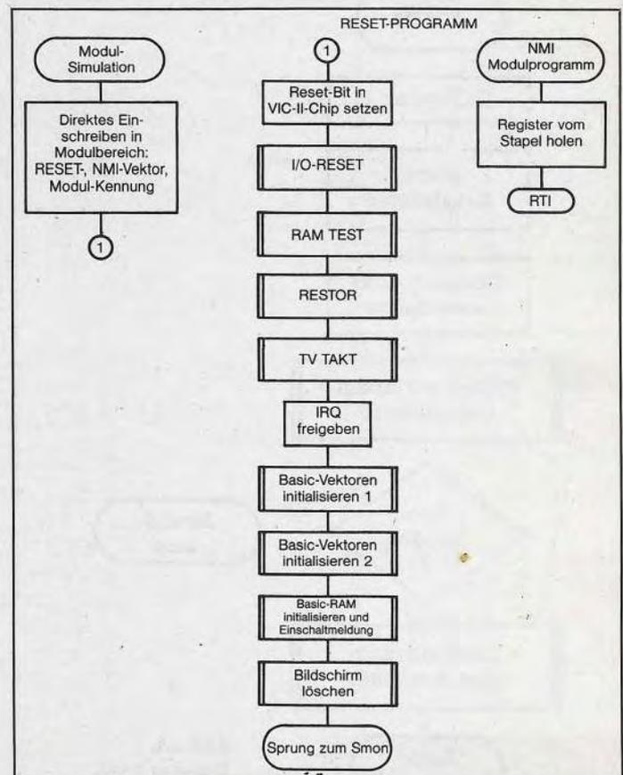
Bild 46. Flußdiagramm zum Programm 6, Modulsimulation.
